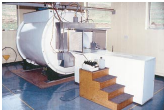
Abbildung 1. Selbstentwickelter Tomograph mit supraleitendem 0.5-T-Magnet.
