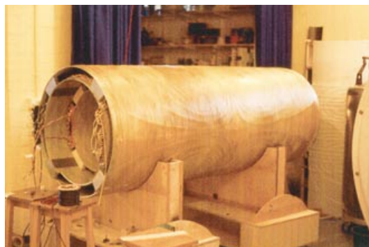
Abbildung 2. Die doppelt abgeschirmte Gradientenspule, die in den in Abbildung 1 gezeigten supraleitenden Magneten eingeschoben wird.
